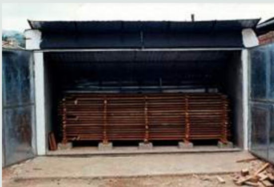
Secador solar de madera, capacidad 500 pie 2 ( \approx 1,18 m 3 ) con paredes de adobe. Izquierda: Vista interior del secador con la cámara de secado parcialmente cargada. Derecha: Vista general del secador solar.
