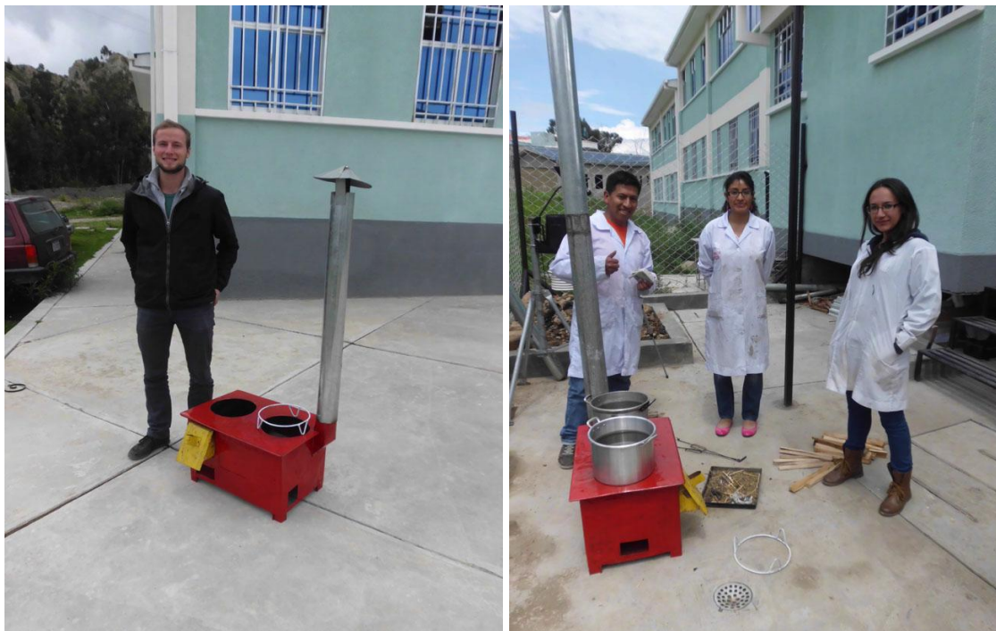
Fotografías 1 y 2: Cocina metálica. La chimenea metálica se puede prolongar hasta una altura de 1,80 m.
