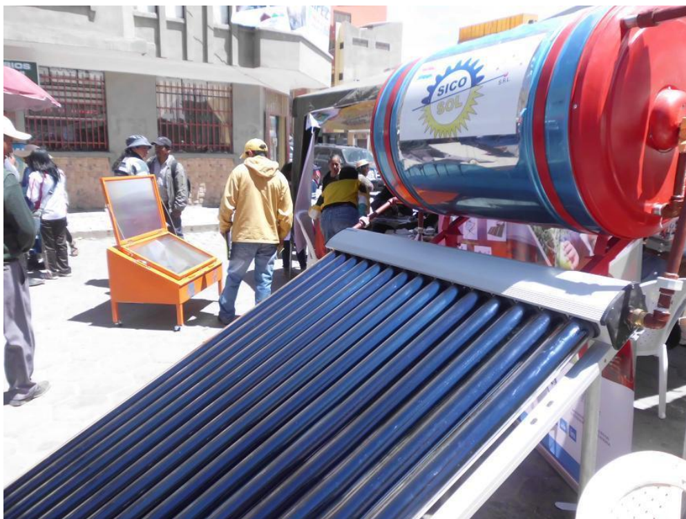
Figura 5: Termo tanque y colector están separados, permite trabajar con presiones elevadas. El almacén de agua caliente (termo tanque) tiene paredes de acero inoxidable.
