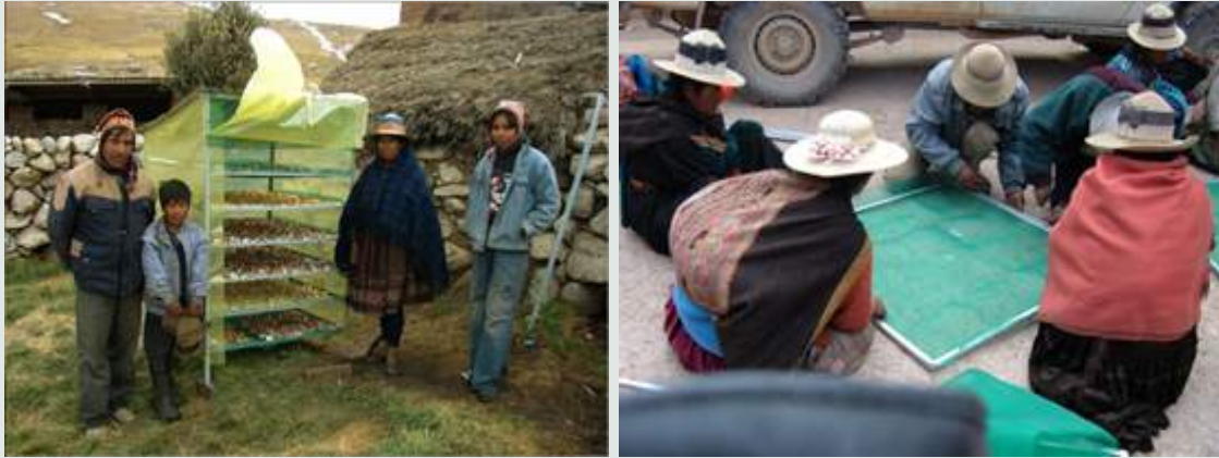
Fotografías 1 y 2: Izquierda: Secador solar familiar en uso en el Norte de Potosí. Derecha: Montando un secador solar familiar con familias campesinas en el Norte de Potosí.
